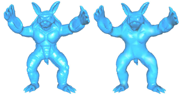
Figure 10 – Surfaces simplifiées par rapport à la courbure à partir d'un volume 512^3 voxels. A gauche, seuil de courbure 0.1, à droite, seuil de courbure 0.9.
