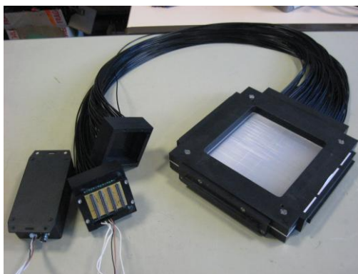
Figure 5 : prototype d'hodoscope 2x128 fibres, avec photomultiplicateur multivoies
