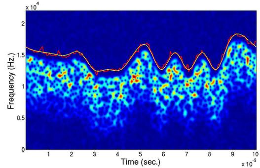
FIG. 1 – Transformée de Gabor d'un signal synthétique de type bande de bruit, superposé avec les courbes de modulation de fréquence vraie (pointillés, jaune) et estimée (traits pleins, rouge).
