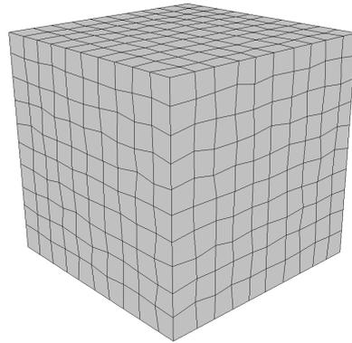
(d) Randomly perturbed grid made of 1000 cells.
