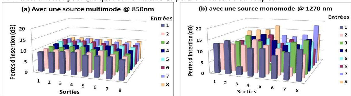
Fig. 3: Pertes d'insertion du coupleur multimode 8 x 8
