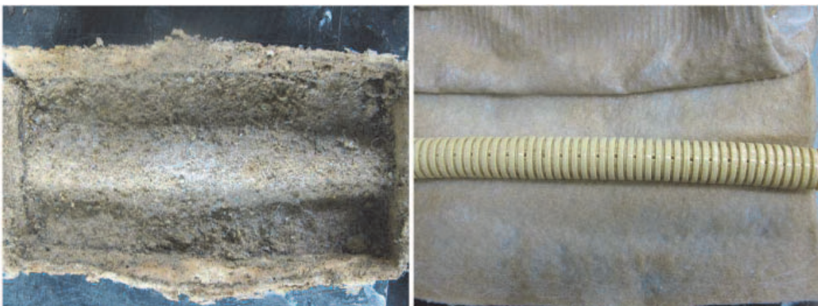
Figure 6. Vue externe et interne du géocomposite après trois mois de filtration du minerai
