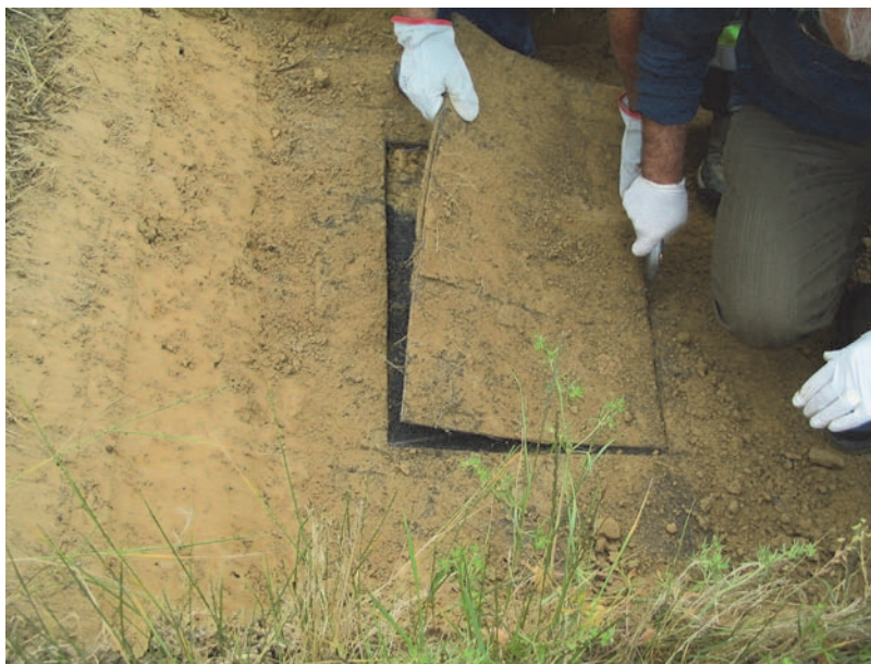
Figure 2. Échantillon de GSB découpé et transféré sur un support rigide.
