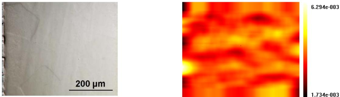
FIG. 8 – Microstructure à gros grains d'une éprouvette de Zircaloy-4 oxydée à 1100 °C (à gauche) et composante  $\varepsilon_{yy}$  du champ de déformation mesuré en traction uniaxiale sur ce type d'éprouvette, pour une déformation macroscopique suivant l'axe y de 0.5%. La taille de la zone d'étude est  $540 \times 430 \mu\text{m}^2$ , la taille des fenêtres de corrélation est de  $24,1 \times 24,1 \mu\text{m}^2$ , et leur espacement est de  $4,8 \mu\text{m}$ .
