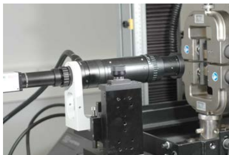
FIG. 2 – Microscope optique longue distance en visée sur une éprouvette de traction.
