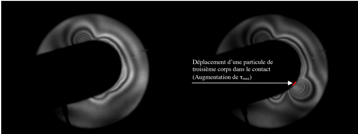
Fig.1.16: visualisation obtenue à 20 000 images/sec
