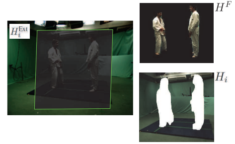
FIGURE 3 – Les régions des supports des différents histogrammes couleur, définis à partir de la région d'intérêt R_i pour la vue i : H_i^{\text{Ext}} pour les pixels d'arrière-plan connus ( R_i^c ), H_i pour les pixels "fond" dans R_i et H^F pour les pixels d'avant-plan (histogramme partagé entre les vues).
