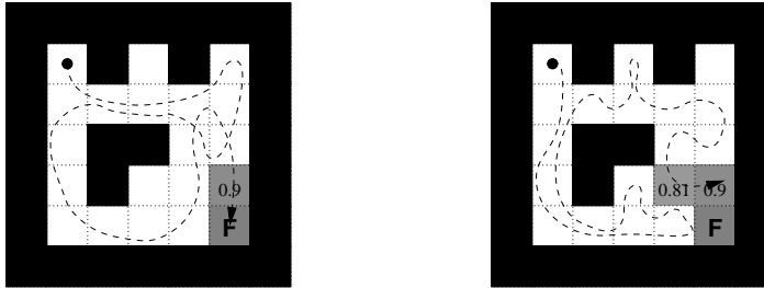
Figure 2.1. Q-learning : premier et deuxième essai. On observe que, toutes les valeurs étant initialement nulles, la propagation de valeurs non nulles ne se fait qu'une fois que l'agent a trouvé une première fois la source de récompense et ne progresse que d'un pas à chaque essai de l'agent.
