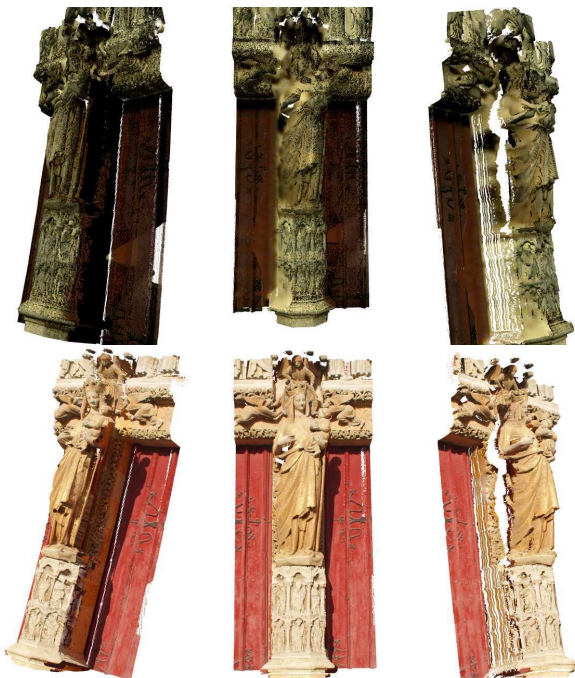
FIGURE 12 – Le nuage de points de la statue de la Vierge Marie avant (au-dessus) et après (en-dessous) la colorisation.
