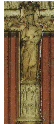
FIGURE 14 – Image du nuage de points de la Vierge Marie générée par Cyclone, le logiciel fourni par Leica.
