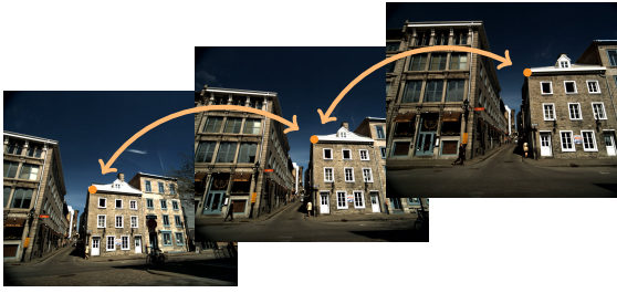
FIGURE 2 – Triplet d’images successives et géoréférencées d’une même séquence, à sur-segmenter à l’aide de la redondance d’information afin d’obtenir des zones cohérentes sur les trois images. Par exemple, le point orange doit se trouver dans un superpixel qui peut être mis en relation avec les superpixels des images adjacentes.
