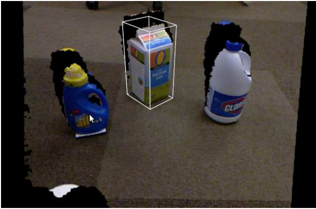
FIGURE 3 – Le résultat après segmentation des plans, segmentation des objets et calcul de la boîte englobante.
