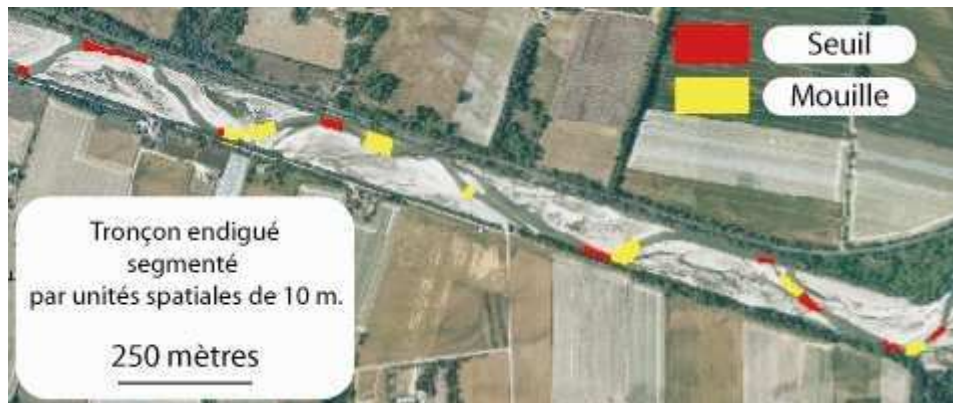
Figure 33 : Pointage manuel des seuils et mouilles au sein d'une zone test
