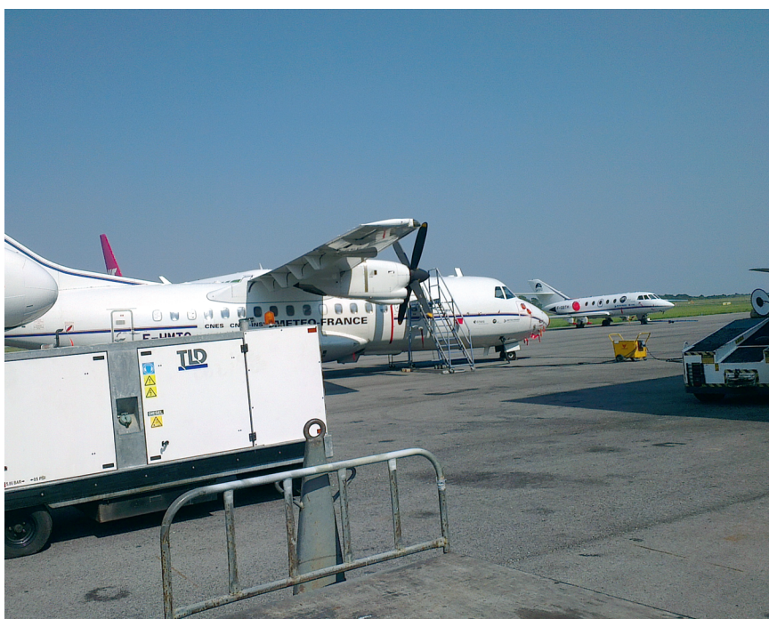
Au deuxième plan l'ATR 42 et au troisième plan le Falcon 20 de SAFIRE. L'ATR 42 a volé en amont des systèmes précipitants pour la documentation des flux d'humidité alimentant les orages et le Falcon 20 a volé à proximité des orages pour documenter les microphysiques des systèmes nuageux. (© CNRS, Philippe Drobinski).
