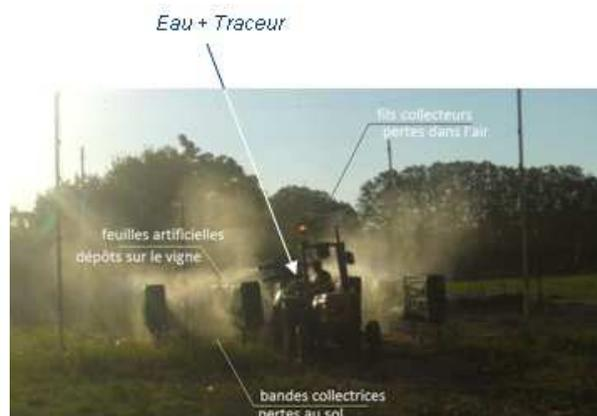
La mesure de la concentration dans l'air est réalisée par quantification directe des molécules actives à l'aide de préleveurs d'air [Marlière 2002]. L'enregistrement des conditions météorologiques (profil de vent, température et hygrométrie) en continu vient compléter les jeux de données (figure.3).
