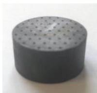
Figure 1 : Pastille YBCO utilisée.
