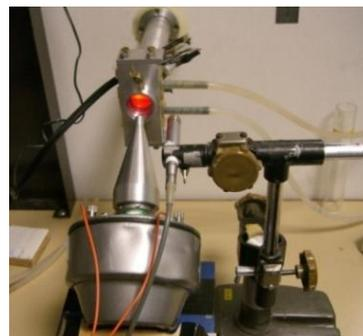
**Figure 4 : Photo du dispositif permettant d'obtenir la réponse mécanique mesurée des cordes vocales**
