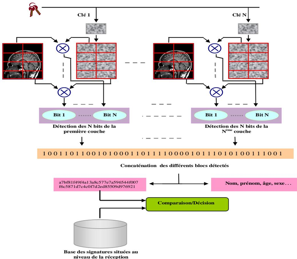
Figure 3. Schéma de détection de la méthode multicouche
