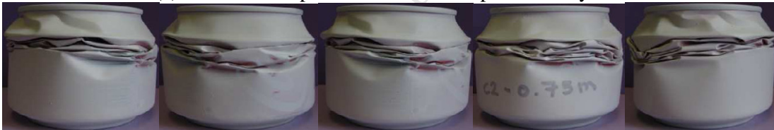
(d) Deformation patterns for initial impact velocity 3.8 m/s
