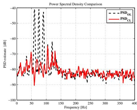
FIG. 3 – DSP du résultat pour IBSF à [60, 75, 90] Hz.
