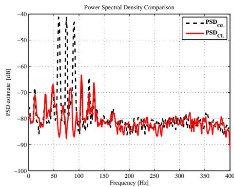
FIG. 4 – DSP du résultat pour DIMP à [60, 75, 90] Hz.
