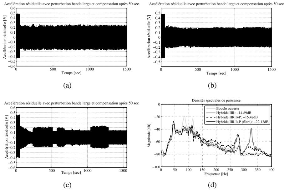
FIGURE 3 – Résultats temps réel obtenus avec : l’algorithme  $I_L$  avec gain scalaire «Intégral» 3(a), l’algorithme  $I_L$  avec gain scalaire IP 3(b) et l’algorithme  $I_{LV}$  avec gain scalaire IP et filtrage de l’erreur d’adaptation 3(c). Densités spectrales de puissance de l’accélération résiduelle sur les 10 dernières secondes de chaque expérimentation 3(d).
