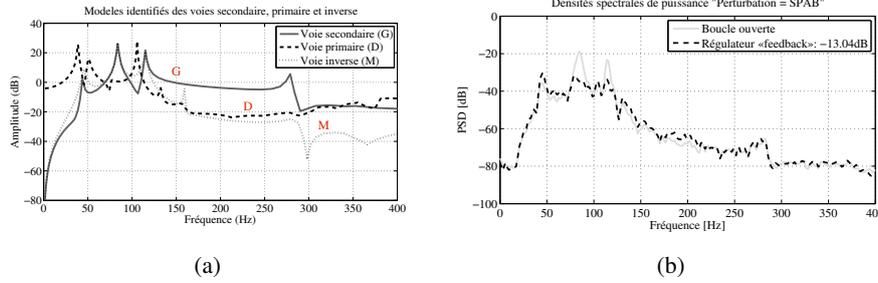
FIGURE 2 – Caractéristiques fréquentielles des modèles des voies primaire, secondaire et inverse 2(a). Densités spectrales de puissance de l'accélération résiduelle en boucle ouverte et avec régulateur «feedback» fixe 2(b).
