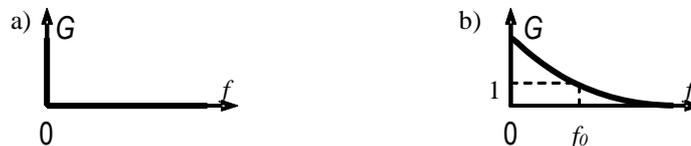
Figure 12. Réponses fréquentielles d'un correcteur PI : a) parfait et b) réel .
