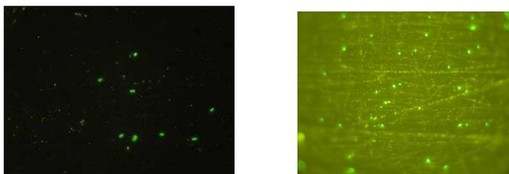
Figure 1 – gauche : immuno-détection de *Salmonella* Typhimurium après immunomarquage Alexa488 sur lames d'inox impactées par de la couenne de porc artificiellement contaminée. Droite : rayures sur lame inox.
