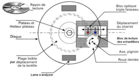
Figure 5 – Principe du balayage et de la synchronisation de la mesure de fluorescence.
