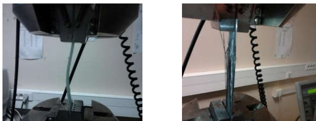
Figure 1 : Essais de flambement et traction en statique des éprouvettes stratifiées
