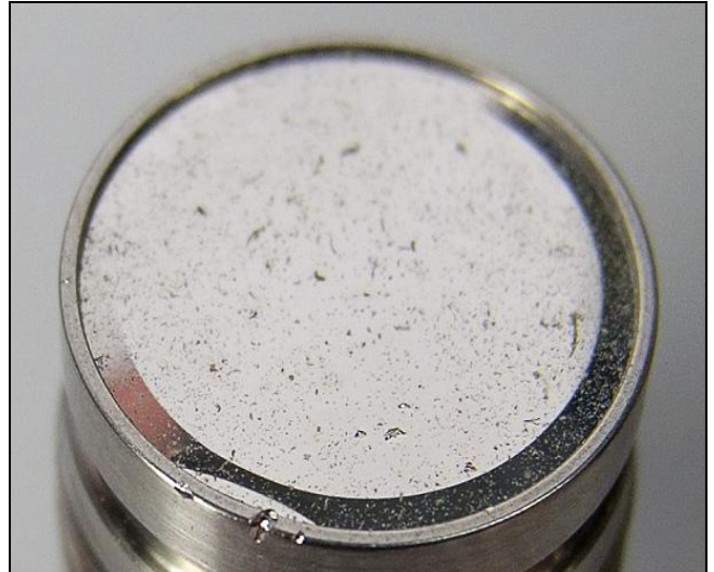
Fig.13: shock on the edge of the membrane
