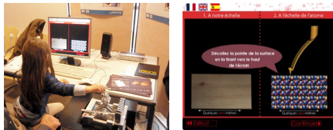
fig 1 : gauche) la plateforme NanoLearner grand public ; droite) représentation visuelle des deux scènes virtuelles interactives, l'une représente une surface de bois, l'autre une nanosurface sondée grâce à une sonde AFM
