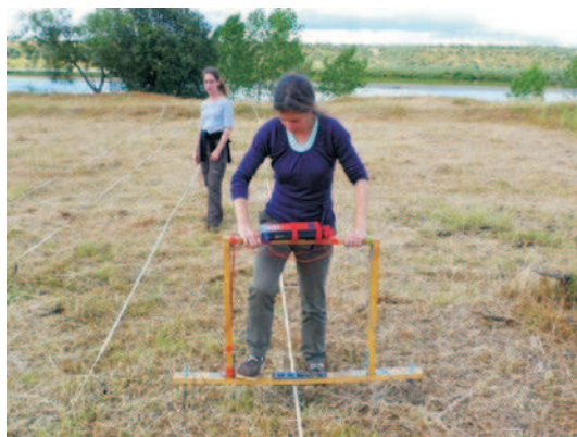
Figura 10. Prospección eléctrica intramuros.
