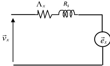
**Figure 2.** Schéma équivalent d'une phase de la machine
