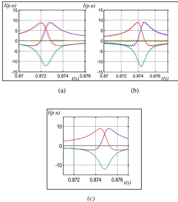
**Figure 16.** Vue rapprochée des courants de phases et de leurs références en (pu) pour : (a) PID, (b) hystérésis à bande fixe, (c) hystérésis à bande adaptative.
