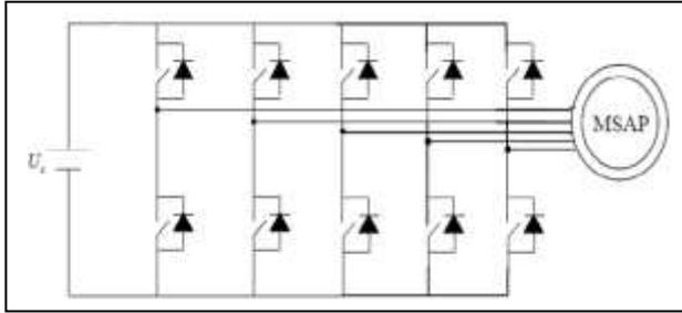
**Figure 1.** Machine à 5 phases couplée en étoile et alimentée par un onduleur de tension à 5 bras.
