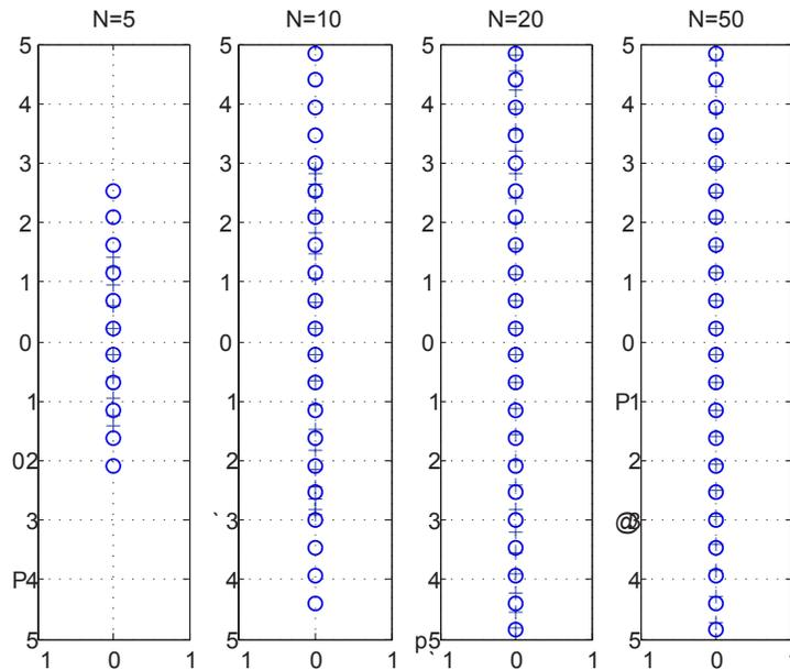
**Figure 3.** Comparaison des valeurs propres du modèle réduit par rapport au spectre discret pour différents  $N$  (o) spectre de la structure de Stokes-Dirac (+) spectre de la structure de Dirac du modèle réduit
