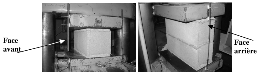
Figure 1. Essai de compression : bloc et prisme
