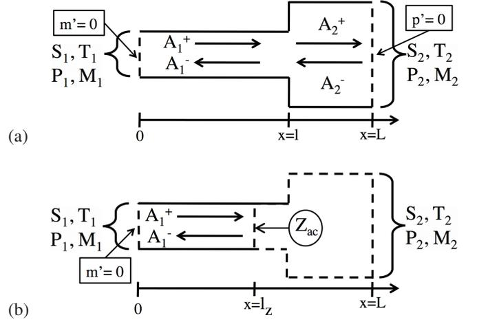
**FIGURE 1.** CONFIGURATION A INVESTIGATED IN SECTION 2. FIGURE (a): THE COMPLETE GEOMETRY IS COMPUTED. FIGURE (b): ONLY A PART OF THE TUBE 1 IS COMPUTED WHILE THE REST OF THE DOMAIN IS MODELLED THROUGH DOWNSTREAM IMPEDANCE.
