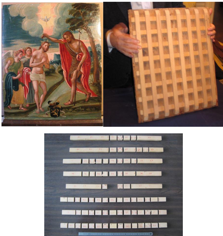
Figure 1 – Baptême du Christ, Palais du Roure, Avignon (en haut, à gauche), son parquetage initial (en haut à droite), et les anciennes traverses (en bas), coupées pour pouvoir être extraites (partie centrale manquante, utilisée pour une caractérisation du matériau)
