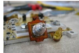
Figure 11. TOSA (à gauche) et ROSA (à droite)
