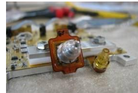
Figure 11. TOSA (à gauche) et ROSA (à droite)
