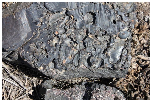
Fig.3 – Scorie de métallurgie (cuivre) Mines de Burra Burra, XIXe s. (Australie) (Photographie D. Morin)
