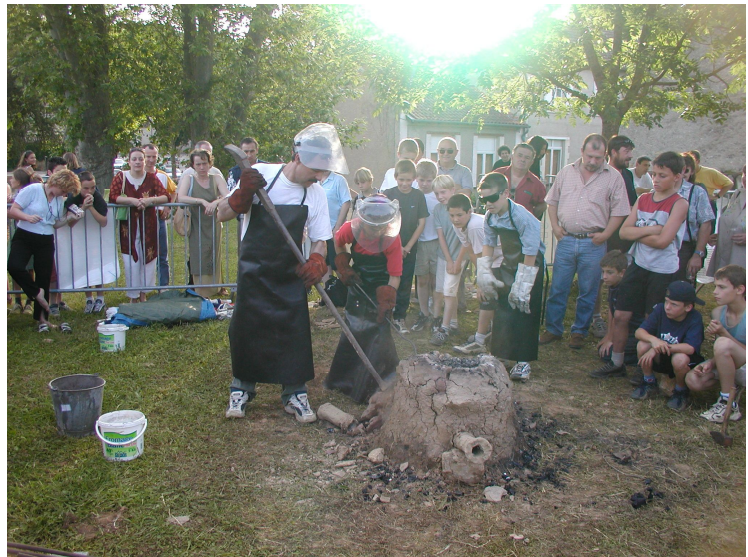
Fig.19 – Bas fourneau de réduction (Fe) Extraction de massiau. 2002 Cahors (Lot) Expérimentation archéologique. (Photographie : D. Morin)
