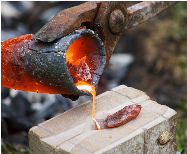
Fig.12 – Coulée de bronze dans un moule bivalve. Montagney – Servigney. Base archéologique expérimentale (Doubs). Expérimentation archéologique. (Photographie : D. Morin)
