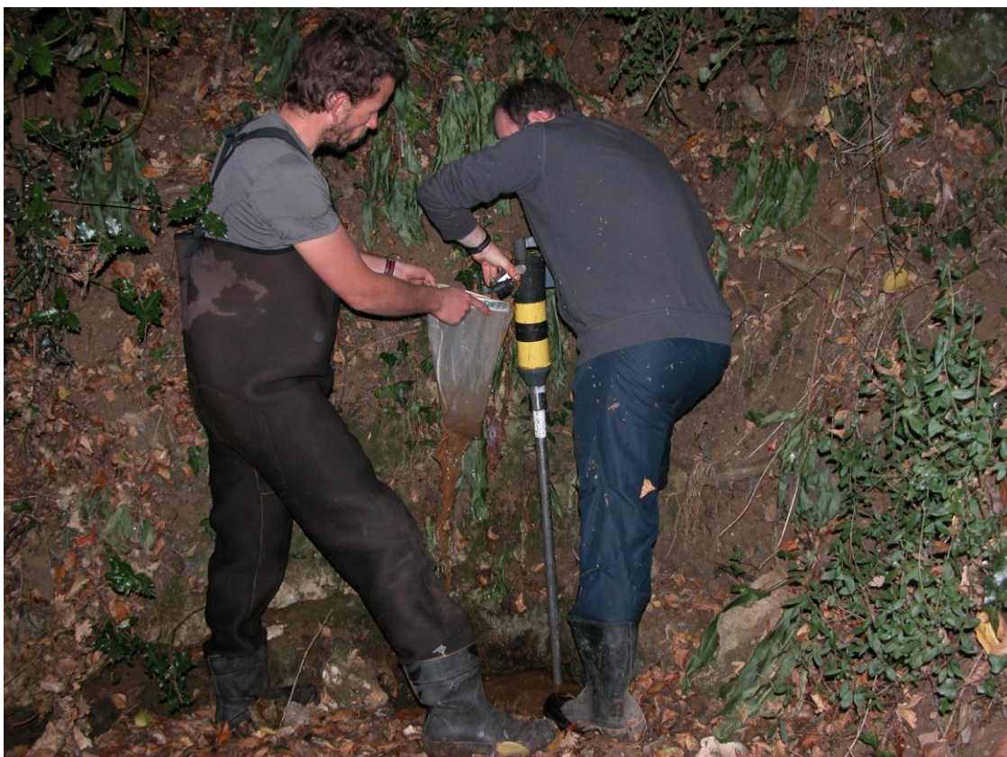
Échantillonnage à la sonde Bou-Rouch dans une des sources de la Sèvre (commune de Sepvret, Deux-Sèvres)
