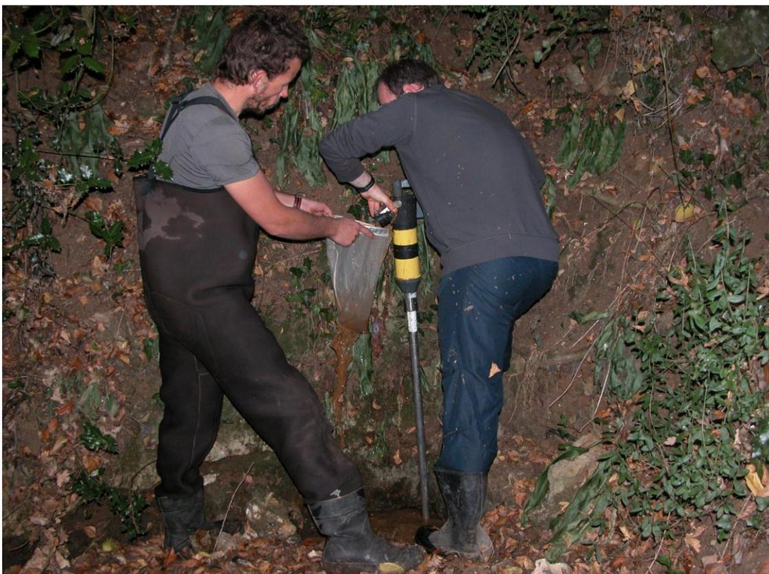
Échantillonnage à la sonde Bou-Rouch dans une des sources de la Sèvre
