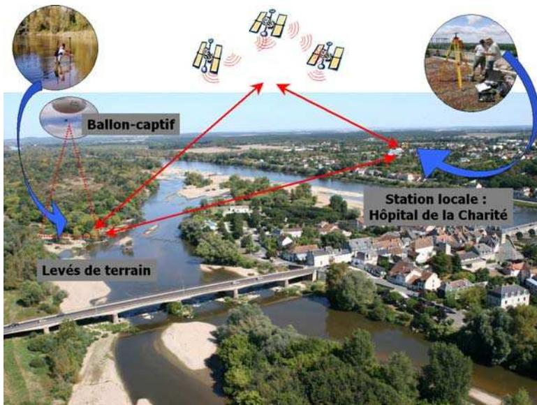
Le recours à une technique originale sur la Loire, un ballon-captif (Fig.20 ) permettant la réalisation de photographies à très haute résolution, constitue un nouveau moyen de compléter les Modèles Numériques de Terrain à très haute résolution altimétrique en 2009 et 2011, et obtenir des vues cavalières du site de La Charité-sur-Loire (offrant ici une intégration de la chevette dans son environnement fluvial).
