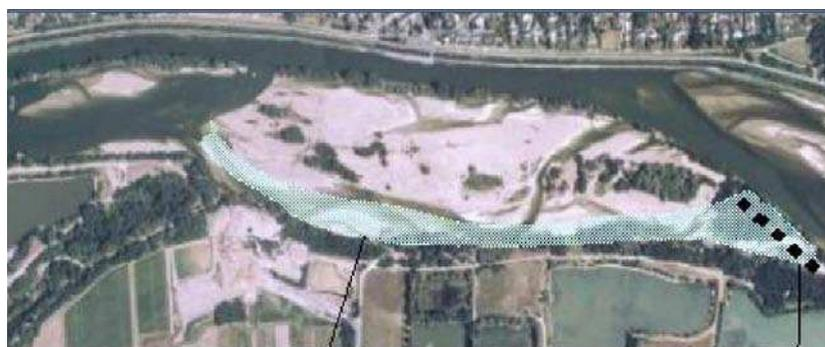
L'objectif premier de ces travaux étaient la restauration du chenal en rive gauche afin d'évacuer les accumulations de sédiments provoqué par le duit et son calibrage le long de la rive gauche.
