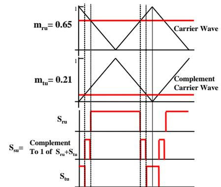
Figure 3 : Modulateur MLI adapté au convertisseur matriciel.
