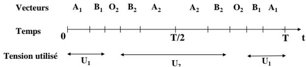
Figure 5 : Séquencement de la modulation Flat Top.
