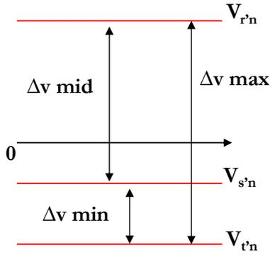
Figure 7 : Ordonnement des tensions simples d'entrée
