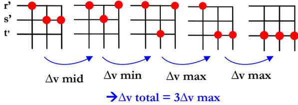
Figure 13 : Séquencement des états générés avec la roue libre sur  $t'$
