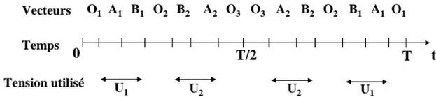
Figure 4 : Séquencement général de la modulation vectorielle.
