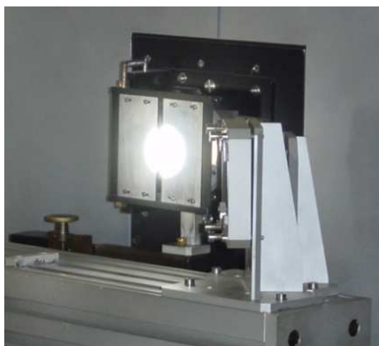
Fente du spectrographe (à gauche) et miroirs du coélostate (à droite)
