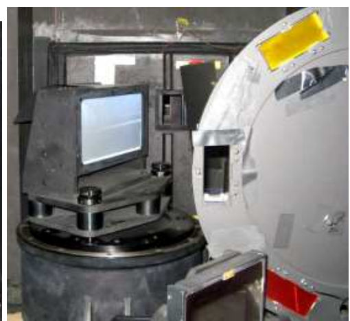
Chambre et collimateur du spectrographe; réseau et filtres sélectionneurs d'ordre
