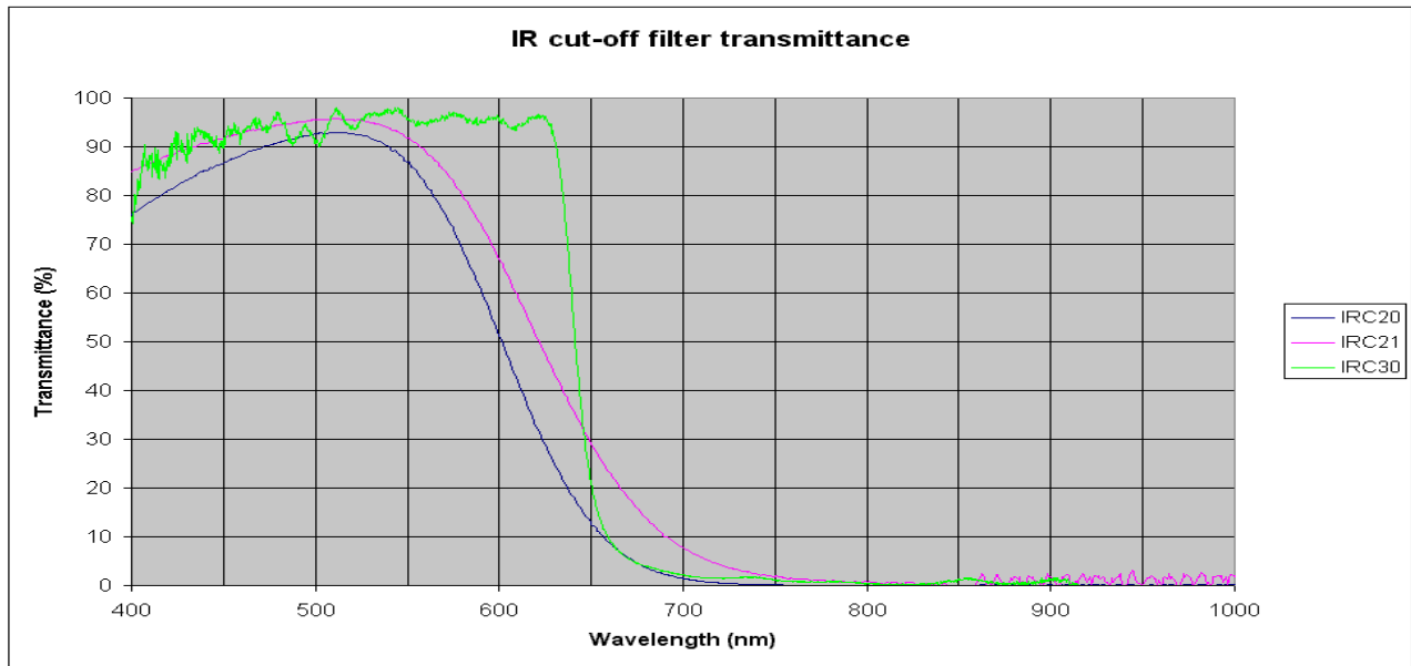
Courbe de transmission du hublot devant le capteur (coupure à 650 nm)
