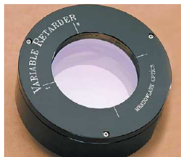
polarimètre: Cristaux liquides et Contrôleur D3040 de Meadowlark Optics via liaison RS232
