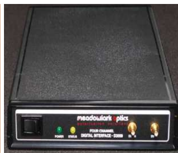
polarimètre: Cristaux liquides et Contrôleur D3040 de Meadowlark Optics via liaison RS232
