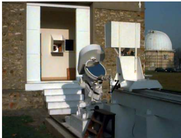
Fente du spectrographe (à gauche) et miroirs du coélostate (à droite)
