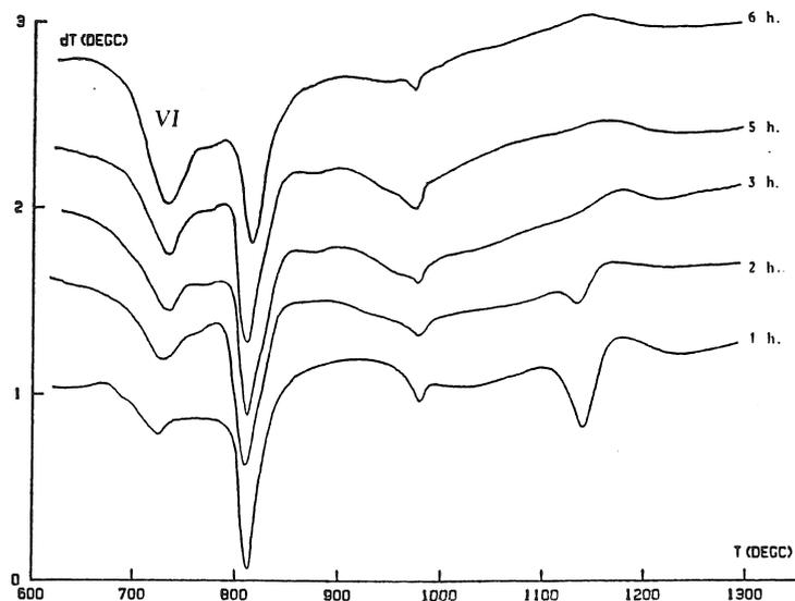
figure 4 : Influence de la durée de broyage à l'attriteur sur les thermogrammes A.T.D. obtenus sous balayage de dioxyde de carbone.
