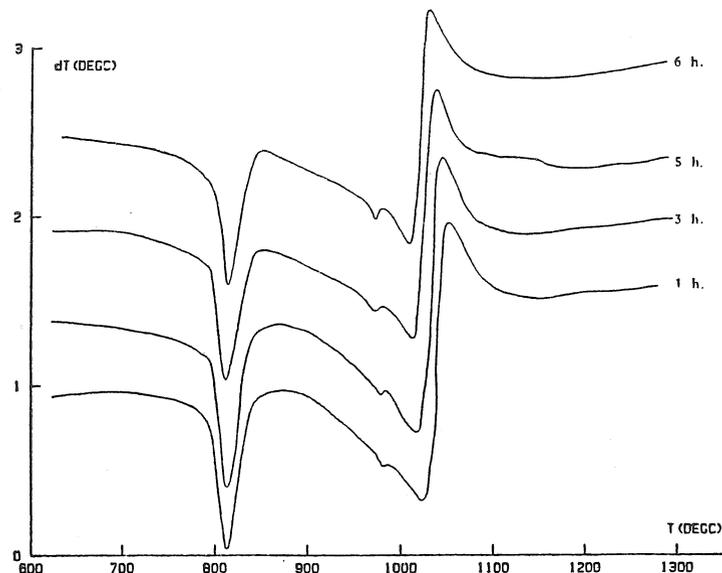
figure 3 : Influence de la durée de broyage à l'attriteur sur les thermogrammes A.T.D. obtenus sous balayage d'air.
