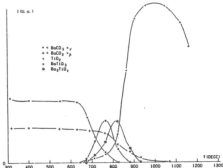
figure 6 : Analyse radiocrystallographique sous balayage d'air d'un mélange obtenu au Turbula.
