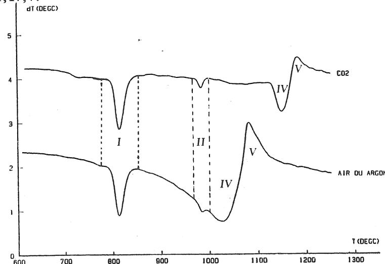
figure 2 : Thermogrammes A.T.D. sous CO<sub>2</sub>, air et argon d'un mélange obtenu au Turbula.
