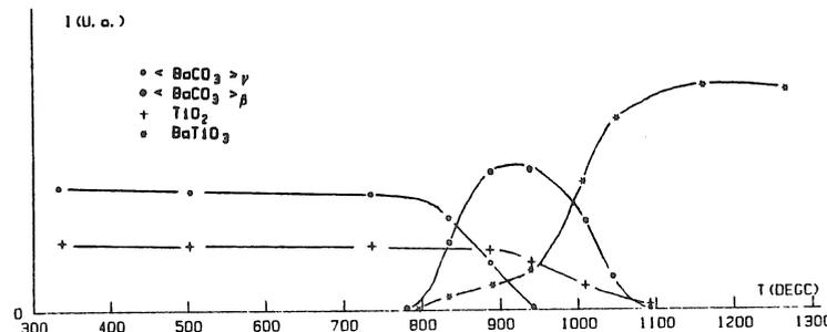
figure 7 : Analyse radiocrystallographique sous balayage de  $CO_2$  d'un mélange obtenu au Turbula.
