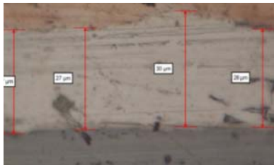
Figure 2 : Micro-section d'un assemblage fritté montrant l'uniformité de l'épaisseur de la couche d'argent frittée
