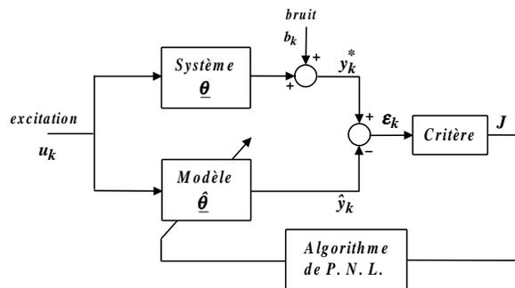
**Figure 1.** Principe des méthodes à erreur de sortie
