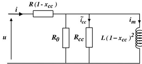
**Figure 9.** Schéma équivalent de la bobine en court-circuit
