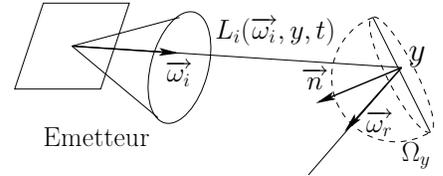
Figure 2 : Phénomène de réflexion d'un flux lumineux
